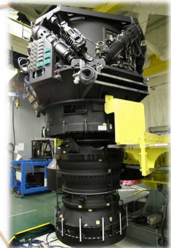
Hyper Suprime-Cam (高さ約3m、重さ約3トン)
