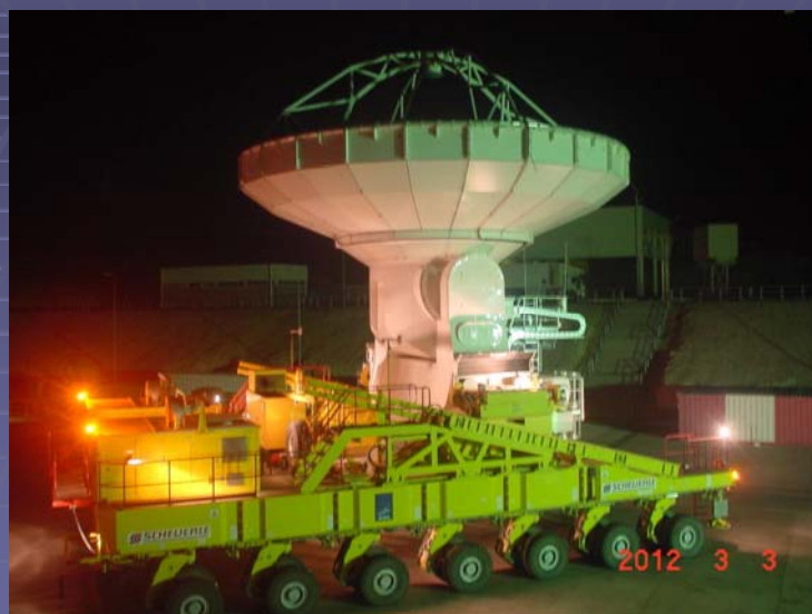
トランスポーターに乗ったアンテナ（この車で山頂までアンテナを運ぶ）
