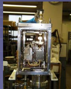
VERAの受信機のデューワー内部 低雑音アンプを冷却して使用する
