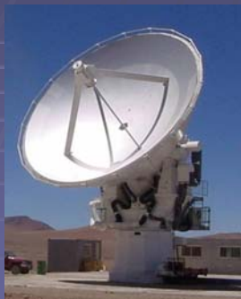
ASTE 10m 望遠鏡 (主に単一鏡観測)
