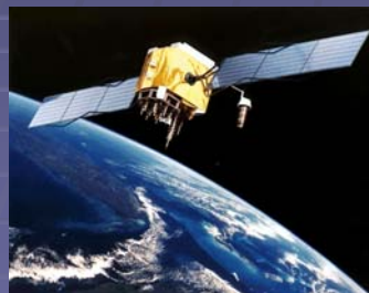
GPS衛星: 衛星には原子時計が積まれ、時刻と衛星位置を地表にむけて送信している
