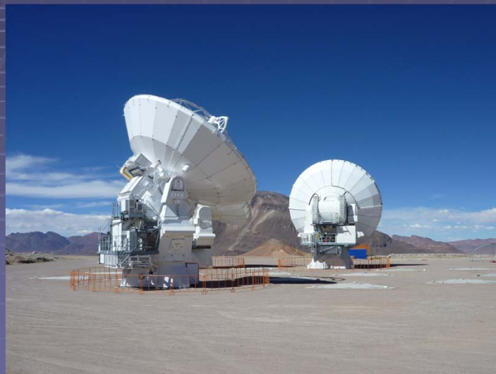
サイト（標高5200m、2010年4月現在3台のアンテナが設置され試験中）
